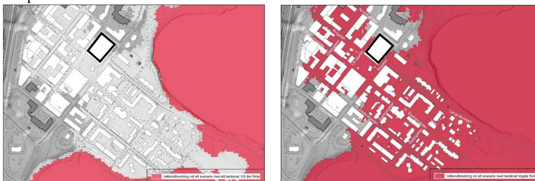
Figur 25. Karta med vattenutbredning vid ett scenario med ett beräknat 100-års flöde samt högsta flöde.
