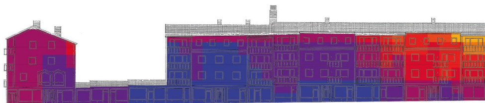
Figur 35. Tillgång till direkt solljus på fasader mot Långgatan 21 mars kl 06-18. Källa DREEM arkitekter
