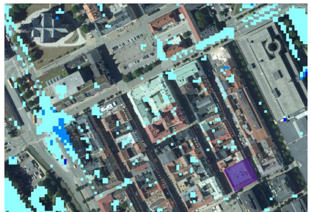
Bild 14. Ovan. Skyfallskartering – Kristianstad 100 års regn (framtagen 2019). Lila markering visar fastigheten. Trots de höga flödena finns inga vattenmassor markerade utmed fastigheten när analysen för "Maximala Vattendjup" är tänd som ovan. Den ljusblå färgen symboliserar vattenytor med ett max djup på 0,1-0,3meter.
