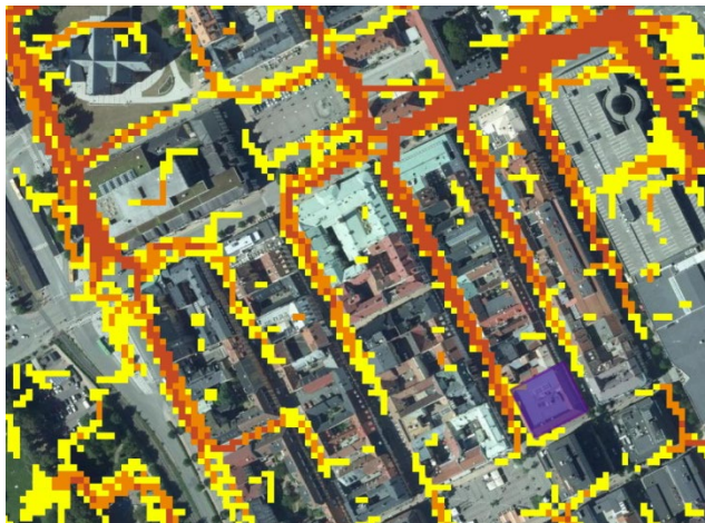
gula till röda färgen visar var flödena är höga. Rött är högst flöde (mer än 10 liter/sekund/meter). Gul är lägst flöde (2-5 liter/sekund/meter).
