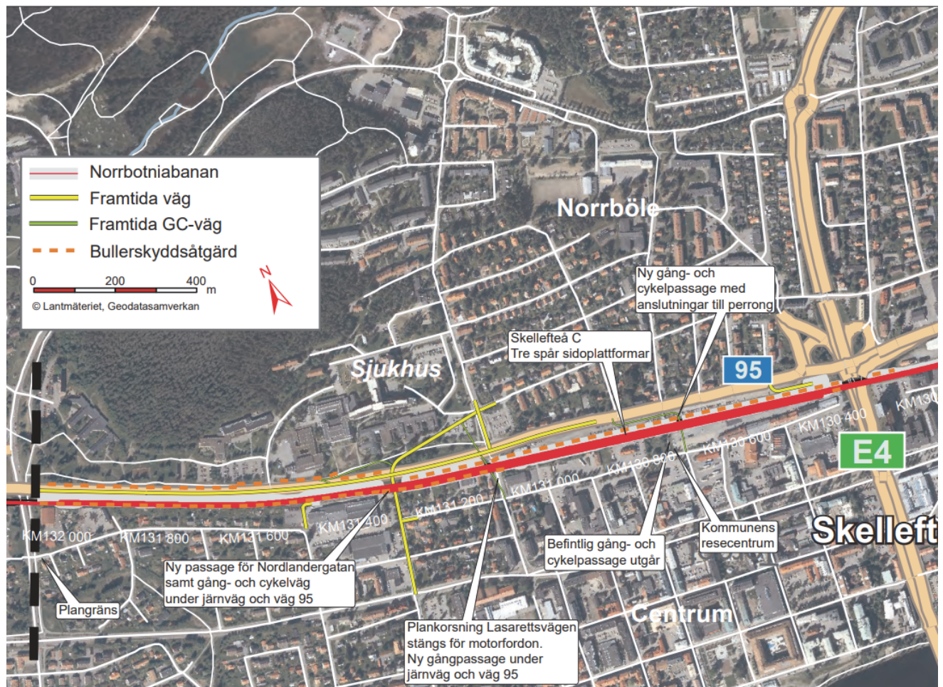
Figur 3: Den planerade järnvägens utformning. Källa: Trafikverket
