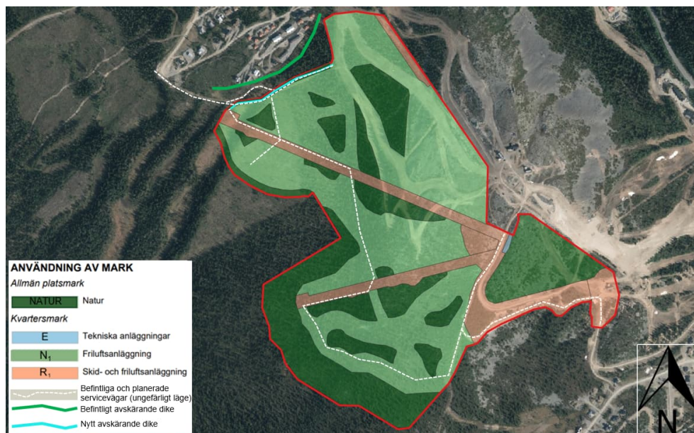
Figur 13. Förslag till dagvattenhantering inom planområdet.
