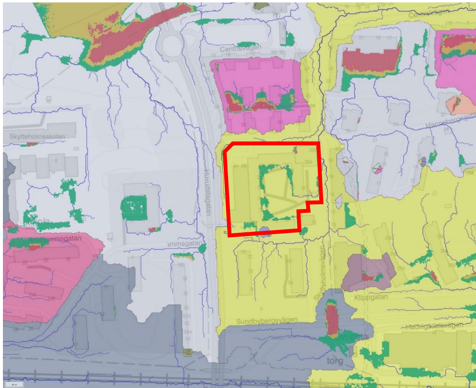
Modellerade avrinningsområden, lågpunkter och avrinningsstråk vid en nederbörd på 50 mm i planerad situation i SCALGO Live. Fastigheten Turkosen 1 ungefärligt markerat i rött.
