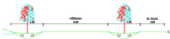
Förslag till gatusnitt för den nya gatan söder om Stenorsvägen. Utrymme finns för trädplantering på båda sidor om cykelvägen. (Kreera 2022-02-17)
