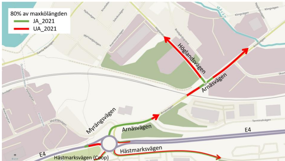
Figur 12. Jämförelse av kölängder, 80 procent av maxkölängd. En pil i slutet av kön visar att kön fortsätter längre än den uppmärkta sträckan.
