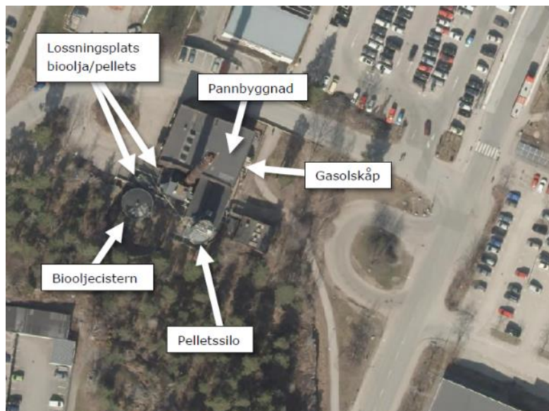
Placering av riskkällor inom panncentralens anläggning.
