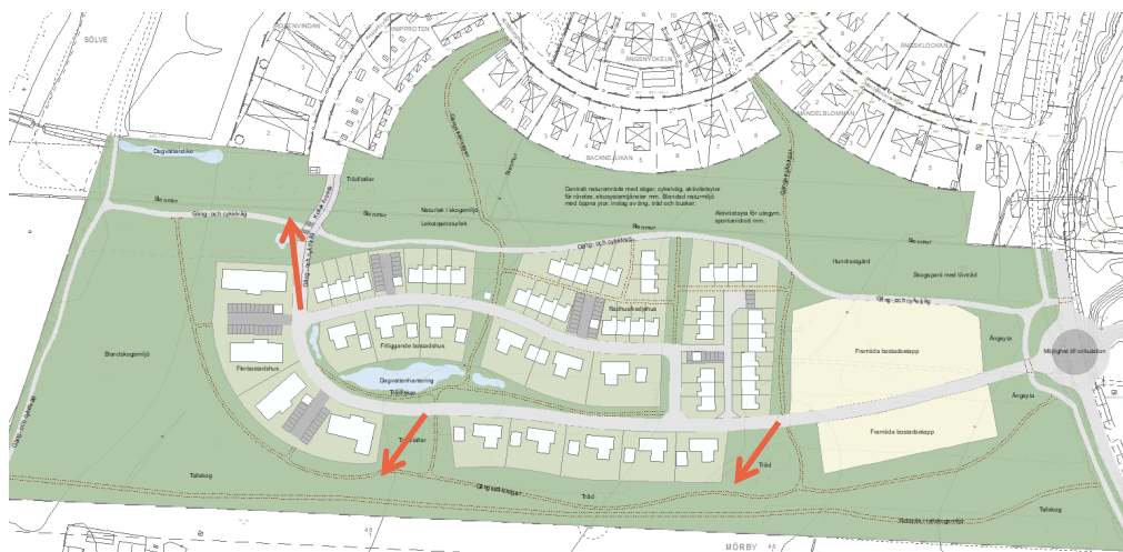
Bilden ovan visar princip för skyfallsleder.
