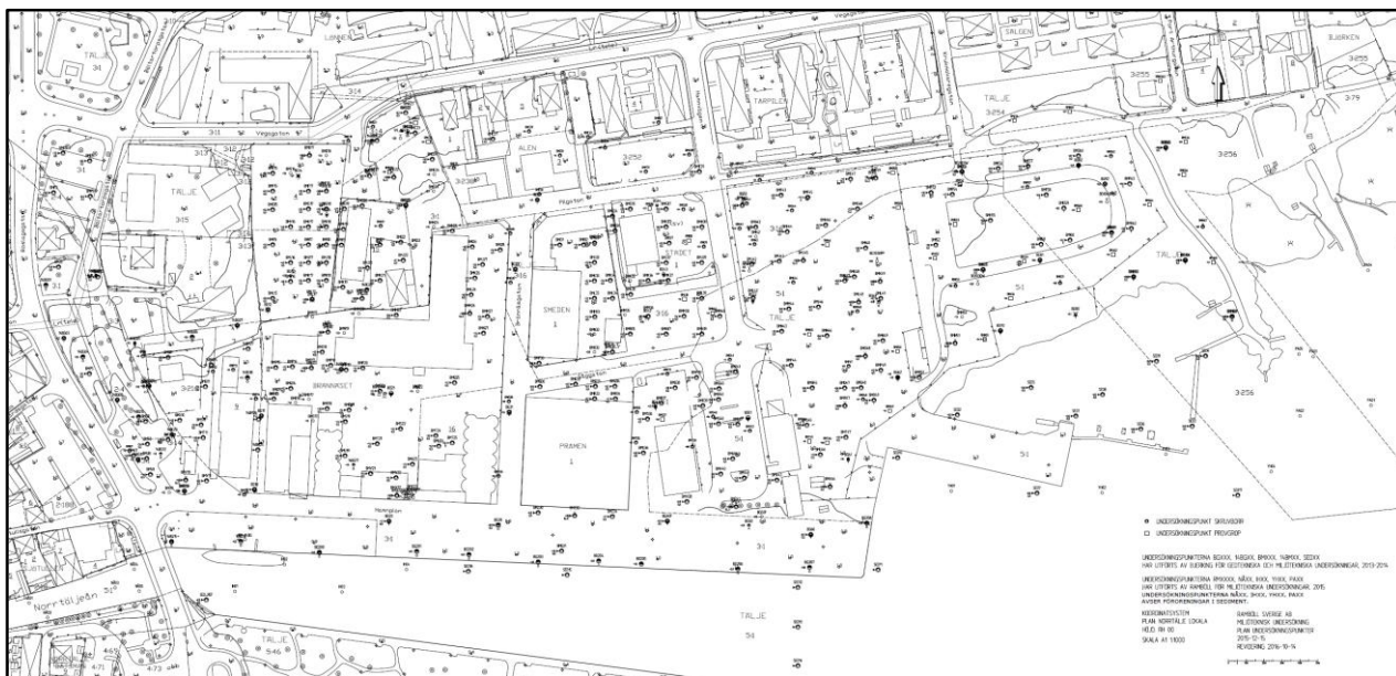
Figur 11. Samtliga provpunkter från övergripande provtagningar i Norrtälje Hamn (Bjerking samt Ramböll). Av ritningen framgår ej prover tagna av Lantmännen inom deras tidigare fastigheter samt prover uttagna under detaljprojektering eller genomförande av efterbehandlingsåtgärder.
