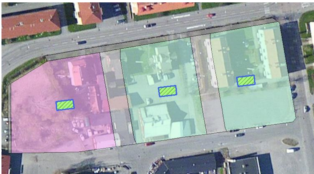
Figur 42. Illustration över erforderlig växtbäddsytta för att kunna fördröja 50 % av ett 10 minuters 20-årsregn.
