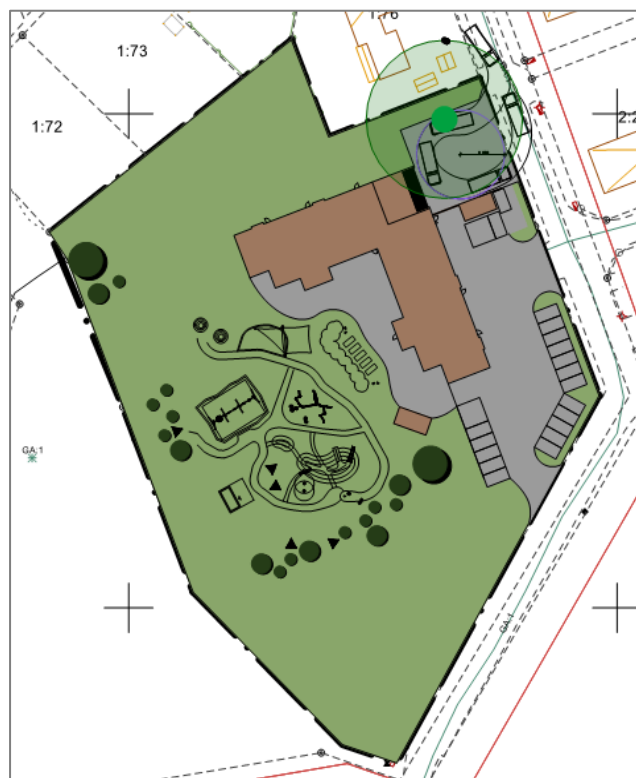
Illustrationskarta som med ljusgrön cirkel illustrerar diametern (16 meter) som behövs för att skydda rotsystemet på Oxeln (särskilt skyddsvärt träd).
