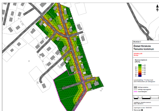
Vägbuller nuläge, maximal ljudnivå (bilaga 3 i trafik- och bullerutredning).
