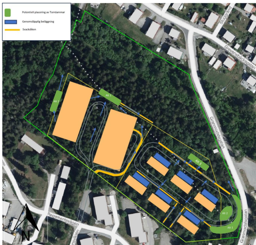
Figur 5: Översiktlig skiss på föreslagen dagvattenhantering hämtad från bilaga Dagvattenutredning, daterad 2023-12-22.
